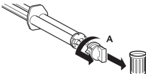
1. Avant la mise en place de la canule de mélange, tourner le bouchon [A] ou la canule de mélange utilisée de 90° dans le sens horaire et le/la jeter.
